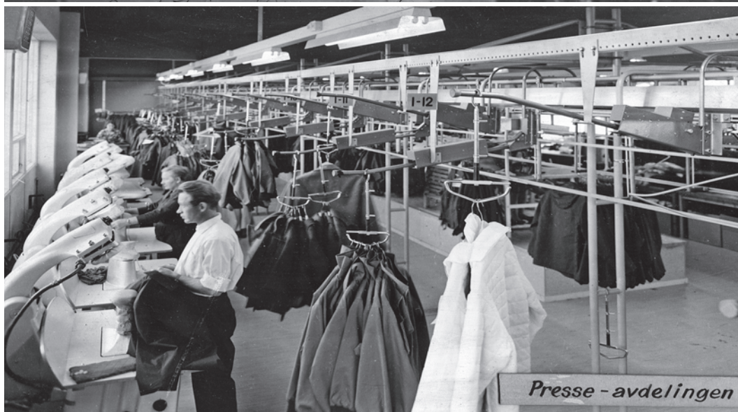
Produksjonshallen på Sorgenfri. Øverst: Transportbåndet som fraktet kasser med stoffdeler frem til den enkelte operasjon. Når plaggene var ferdig sydd, ble de hengt på henger og fraktet med "hengetransportøren" til pressing og ferdigkontroll og tilslutt ut på ferdigvarelageret (nederste bilde).
