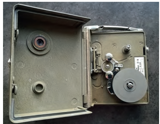
Nizo Helimatic – anskaffet ca 1954. Til høyre ser vi hvordan filmen måtte tres for hånd. Det måtte skje i mørke for å unngå lys på.
